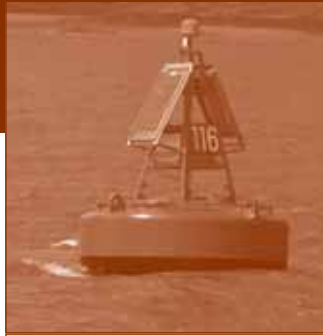
Zeeboei met PV-modules (Soltech)
