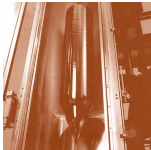
Een monokristallijne siliciumcilinder waaruit siliciumschijven voor monokristallijne cellen gezaagd worden
