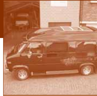
PV-modules op een kampeerwagen (Lenoir Solar)
